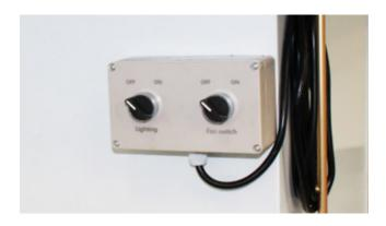
Équipée de seulement deux interrupteurs : lumière et ventilation, la CP-1200 est une machine très simple d'utilisation.
