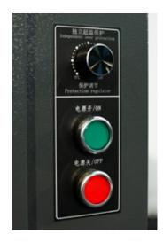
Deux boutons de fonctionnement : marche et arrêt, ainsi qu'une molette de réglage de température en font un four très simple d'utilisation.
