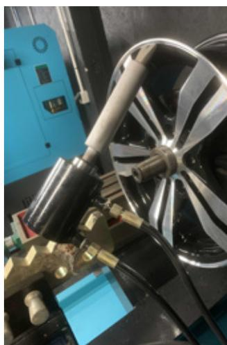
Le système de vérin hydraulique mobile vous permettra d'exercer la force nécessaire au redressage de la jante très facilement sans utiliser de pression excessive.
