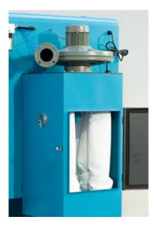
Divers types de grains peuvent être utilisés selon les différentes exigences de processus, et le grain est automatiquement recyclé grâce au séparateur cyclone qui assure une séparation efficace du sable en suspension et de la poussière, récupérant le sable utilisé et réduisant la charge sur le sac filtrant.
