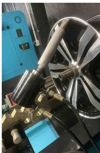
Le système de vérin hydraulique mobile vous permettra d'exercer la force nécessaire au redressement de la jante très facilement sans utiliser de pression excessive.
