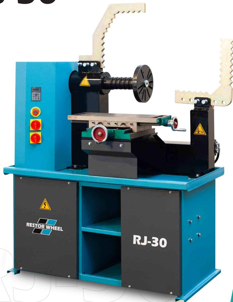
La redresseuse de jantes RJ-30 Restor Wheel® est conçue pour réparer les déformations de vos jantes en alliage.
