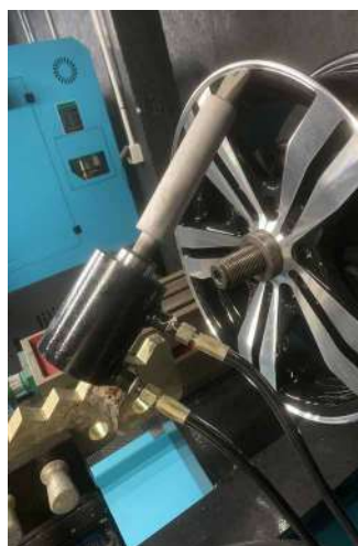
Les systèmes de vérin hydraulique mobiles vous permettront d'exercer la force nécessaire au redressage de la jante très facilement sans utiliser de pression excessive.
