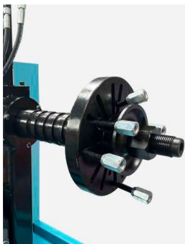
La jante endommagée vient se fixer par son moyeu sur la broche.
